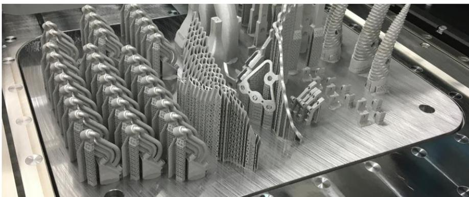
Abbildung 1: Chromstahl-Baujob auf einer Grundplatte der Dimension 400mm x 325mm
